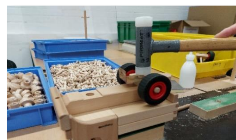
Hier sieht man die Endmontage des Unimogs. Achsen werden angebracht. Dieses geschieht aktuell noch fast ohne Vorrichtung
